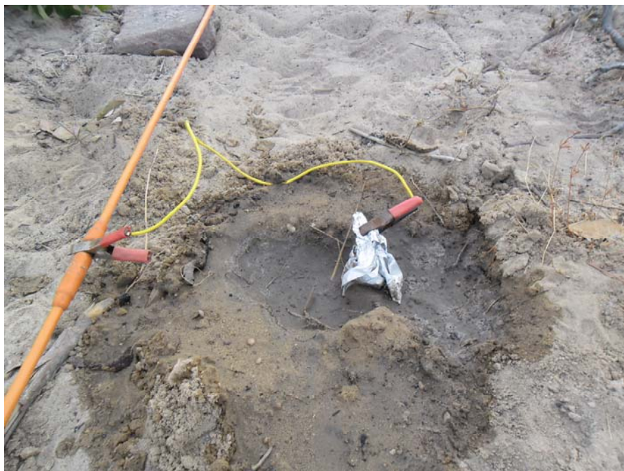
Figura 3.8 - Detalhe do eletrodo de “Papel alumínio” conectado ao cabo multieletrodo.
