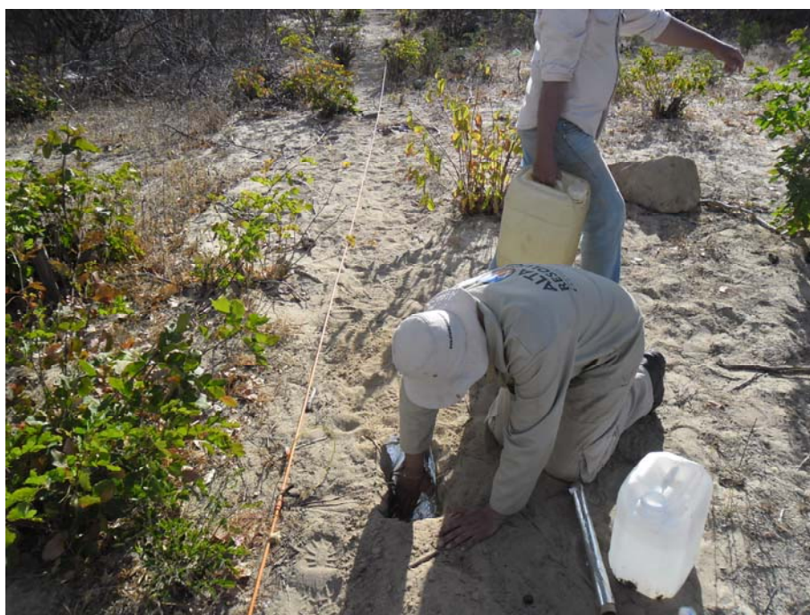
Figura 3.7 - Instalação do eletrodo de "Papel alumínio" visando melhorar o acoplamento galvânico com o solo.
