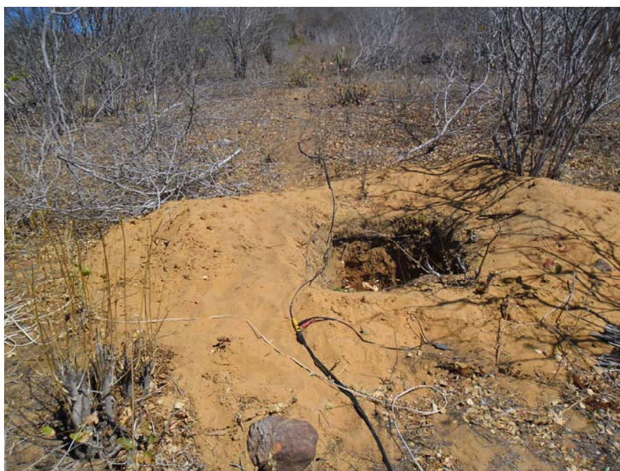
Figura 3.11 - Detalhe do cabo sismográfico e de um dos geofones instalados ao longo do alinhamento.
