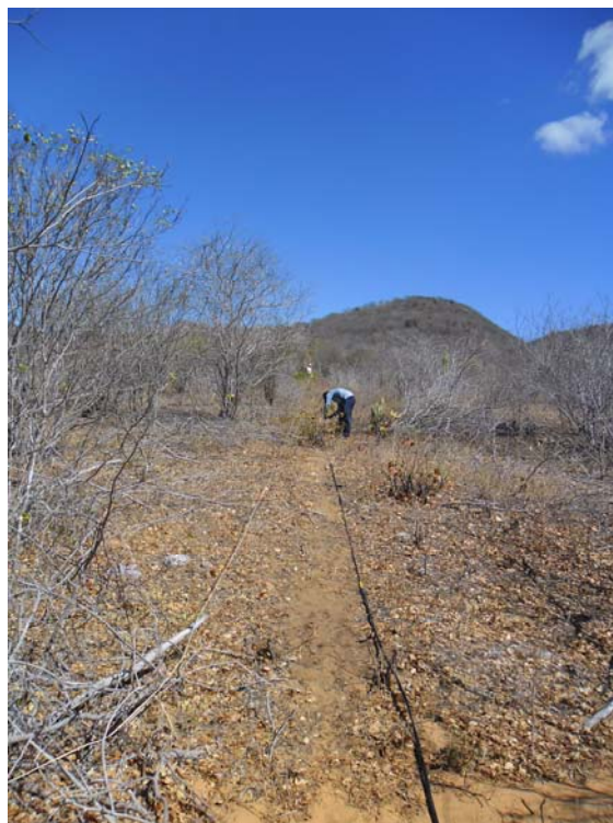
Figura 3.10 - Membro da equipe estendendo o cabo sismográfico e acoplado os geofones.
