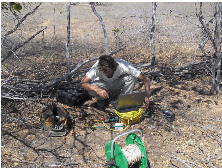
Figura 3.12 - Equipamento sísmico (Geode – Geometrics Inc.) e técnico da Alta Resolução acompanhando a aquisição de dados.
